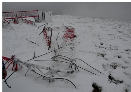
Рис. 12. Руйнування із згином секції 47 (ближній план)
