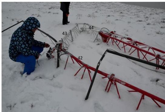
Рис. 11. Розрив 42 секції та згин 44-ї (на передньому плані секція 41)
