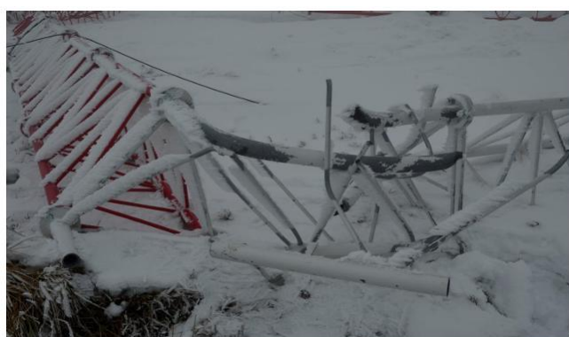
Рис. 10. Згин із ламом секції 19 (характерне прямолінійне руйнування труби у вигляді «зрізу»)
