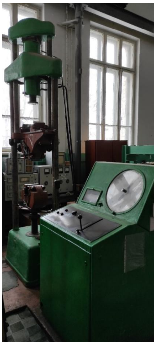
Рис. 4. Загальний вигляд установки УММ-50 (для випробування бетонних призм на розтяг).
