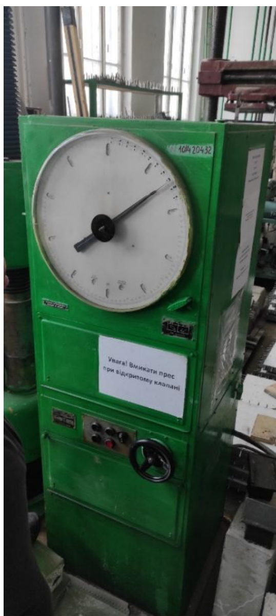
Рис. 5. Загальний вигляд установки ПГ-250 (для випробування бетонних кубів і призм на стиск).
