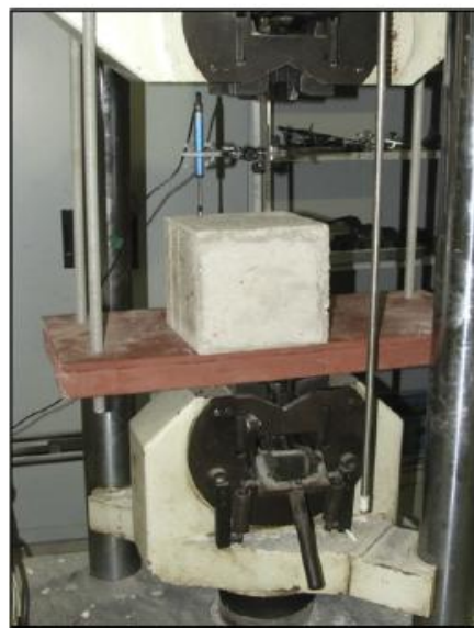
Рис. 2. Випробування на витягування сталевих арматурних стрижнів із бетону і сталевібробетону [5; 6].
