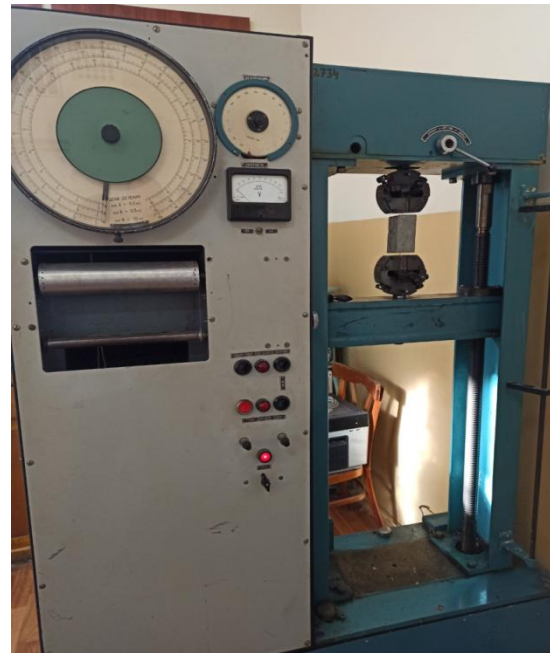
Рис. 1. Випробування фібри на витягування з бетонних призм.
