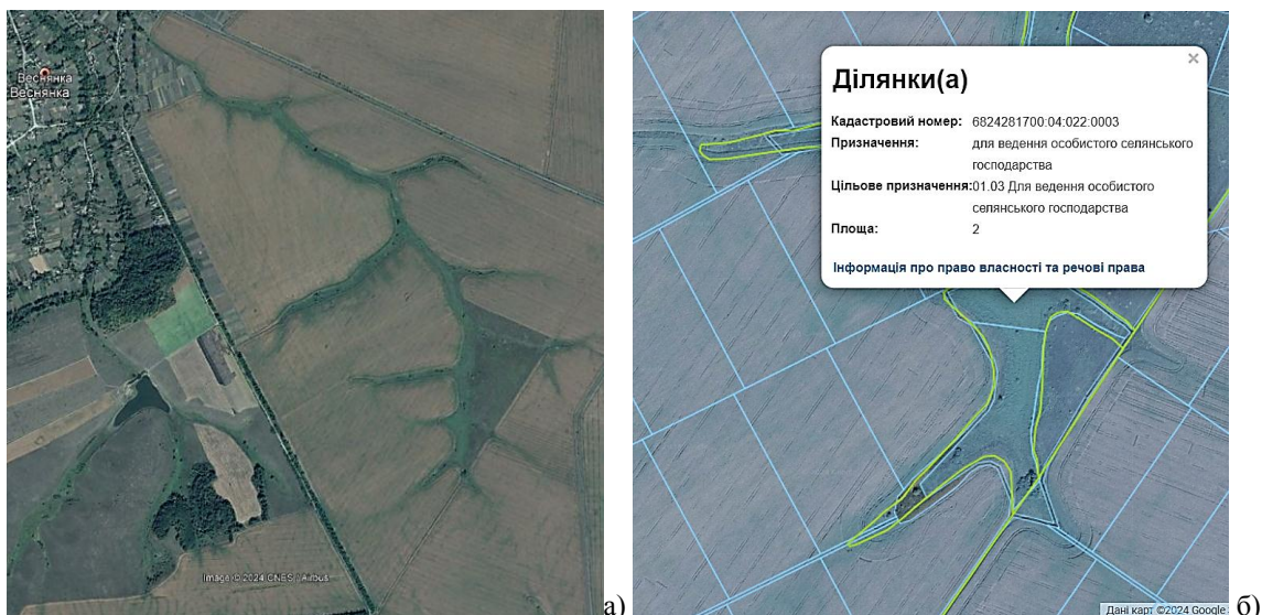
Рис. 4. Фрагменти космознімків масиву земель сільськогосподарського призначення у межах Старокостянтинівської міської громади Хмельницької області: а) процеси ярутворення; б) кадастровий поділ (сформовано авторами з використанням [16; 17])
