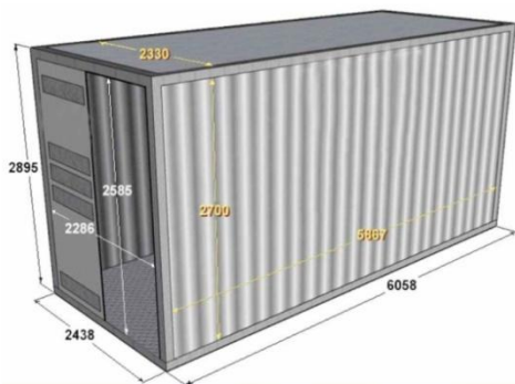
Рис. 4. Розмірні параметри 20-футового морського контейнера
