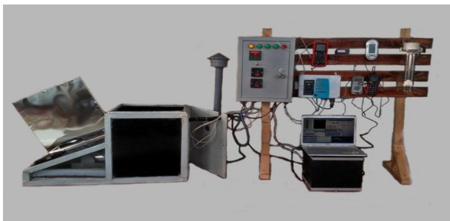
Рис. 1. Геліосушарка з тепловим акумулятором та плоским дзеркальним концентратором: a – конструктивно-технологічна схема; б – загальний вигляд; 1 – вхідний канал; 2 – вентилятор з нагрівачем; 3 – повітропровід; 4 – повітряний колектор; 5 – теплоакумулюючий матеріал (на основі гальки); 6 – сушильна камера; 7 – витяжний канал; 8 – решета; 9 – плоский дзеркальний концентратор; 10 – заслінка
