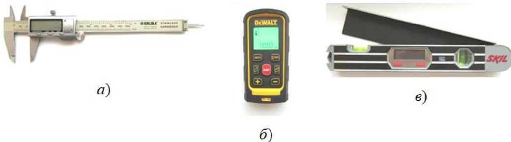
Рис. 3. Прилади для вимірювання розмірних показників крони горіха волоського: а – штангенциркуль SIGMA; б – лазерний вимірювач відстані (далекомір) DW040P; в – кутомір Skil0580AA
