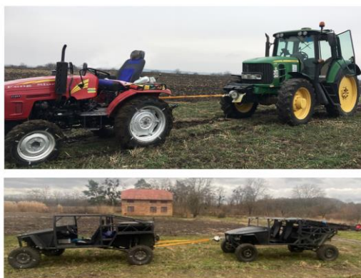
Рис. 3. Тягові випробування на базі автомобіля «Мамай» та трактора Mahindra Feng Shou FS244
