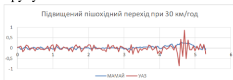
Рис. 7. Запис вертикальних прискорень сидіння водія ( m/s^2 ) при проїзді пішохідного переходу із швидкістю 30 км/год (4-5 секунди запису)
