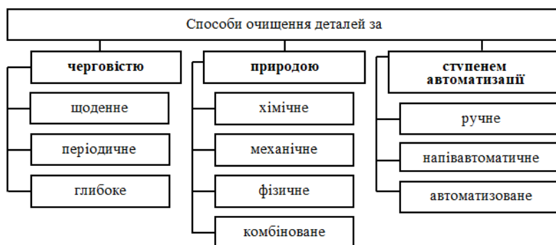
Рис. 2. Класифікація способів очищення деталей та пристроїв Fig. 2. Classification of cleaning methods for parts and devices
