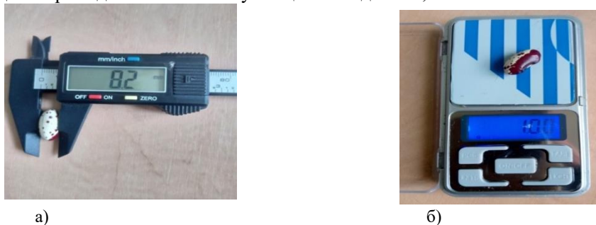
а) б) Рис. 1. Вимірювання розмірних а і масових показників квасолі б Fig. 1. Measurement of dimensional a and mass indices of beans b
