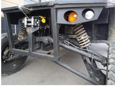
Рис. 2. Передня довгоходова підвіска на поперечних А-подібних важелях (легкий ударний автомобіль – баггі ТУР КВ 02 «Мамай»)
