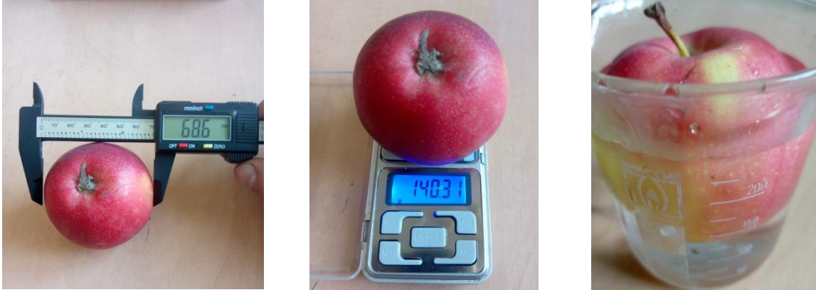
Рис. 2. Вимірювання розмірних і масових показників яблук сорту Гала Fig. 2. Measurement of dimensional and mass indicators of apples of the Gala variety
