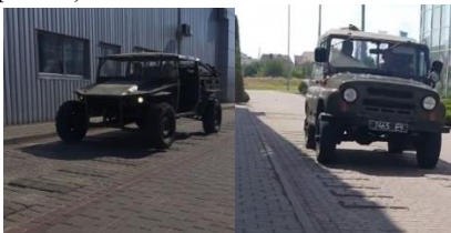
Рис. 4. Автомобілі підвищеної прохідності ТУР KB 022 «Мамай» та УАЗ 3151 під час випробувань – оцінки плавності руху на спеціальній тестовій ділянці
