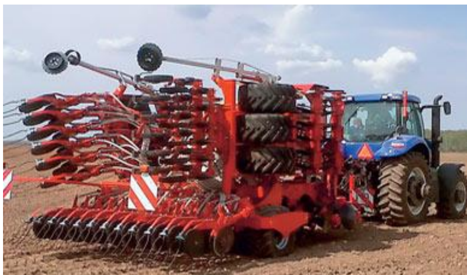
Рис. 1. Посівний машинний агрегат для прямої сівби озимого жита на базі сівалки Pöttinger Terrasem C6
