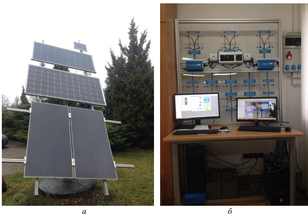
Рис. 1. Експериментальний стенд: а) фотоелектричні панелі; б) моніторингова система Fig. 1. Test stand: а) photovoltaic panels; б) system monitoring
