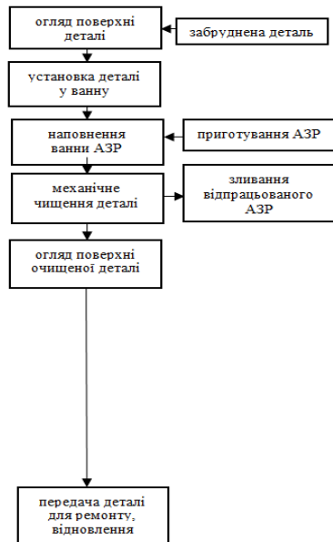
Рис. 3. Технологічна схема очищення деталей традиційним способом Fig. 3. Technological scheme of parts cleaning in the traditional way
