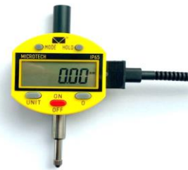
Рис. 2. Цифровий індикатор МІКРОТЕХ ИЧЦ-13 Fig. 2. Digital Indicator MICROTTECH ICHC-13
