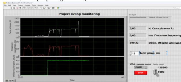
Рис. 3. Робоче вікно експериментального дослідження сили різання з використанням екранного інтерфейсу віртуального осцилографа
