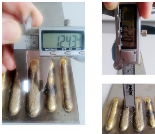
Рис. 3. Вимірювання розмірів зварного шва Fig. 3. Measuring of weld dimensions
