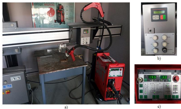
Рис. 1. Установка для автоматичного зварювання:
