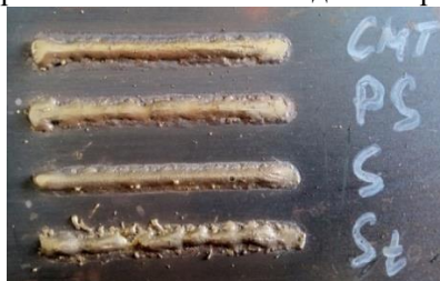
Рис. 2. Наплавлені валики методом MIG-паяння в режимах:
