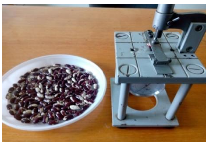
Рис. 2. Процес визначення зусилля руйнування квасолі Fig. 2. The process of determining the breaking force of beans
