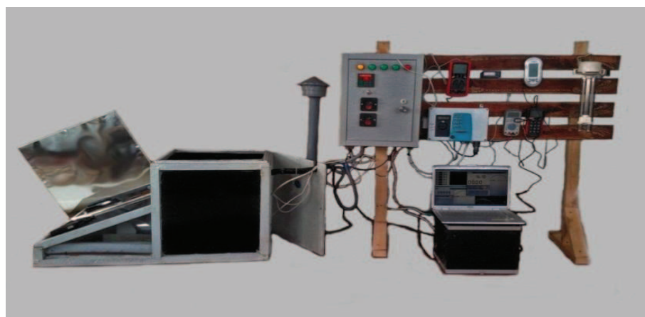
Рис. 1. Геліосушарка з тепловим акумулятором та плоским дзеркальним концентратором: a – конструктивно-технологічна схема; б – загальний вигляд; 1 – вхідний канал; 2 – вентилятор з нагрівачем; 3 – повітропровід; 4 – повітряний колектор; 5 – теплоакумуючий матеріал (на основі гальки); 6 – сушильна камера; 7 – витяжний канал; 8 – решета; 9 – плоский дзеркальний концентратор; 10 – заслінка
