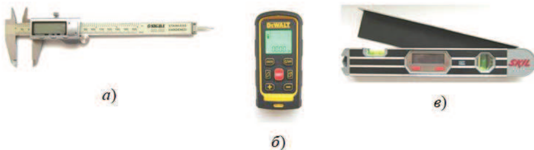
Рис. 3. Прилади для вимірювання розмірних показників крони горіха волоського: а – штангенциркуль SIGMA; б – лазерний вимірювач відстані (далекомір) DW040P; в – кутомір Skil0580AA
